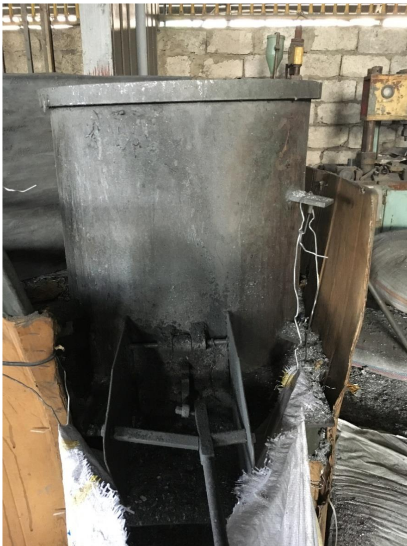
სურათი 2.4.2.6.1. ალუმინის ქილის დასაფქვავე დანადგარი (თვითნაკეთი)
