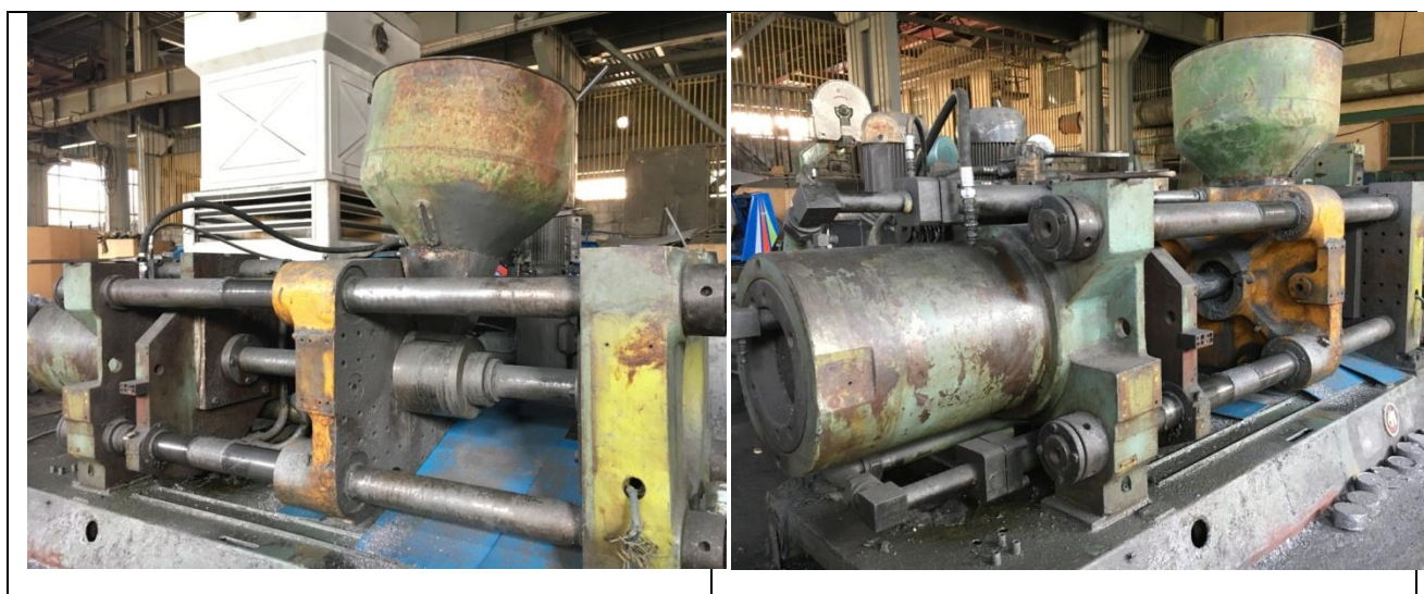
სურათი 2.4.2.6.2. დაქუცმაცებული ალუმინის დასაწნეხი დანადგარი (თვითნაკეთობა)
